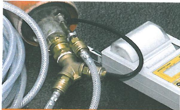
Gerät zur Dichtheitsprüfung mit Luftdruck
