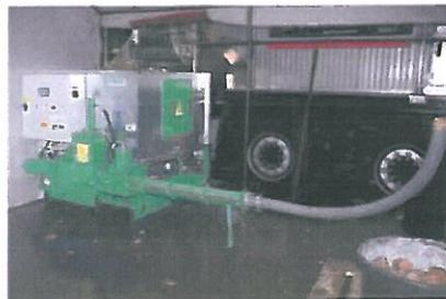
Abbildung 4 Das Biomassepressen wird das Laub zu Briketts
