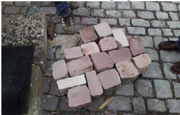
Bsp. Großsteinpflaster Oberfläche gesägt
