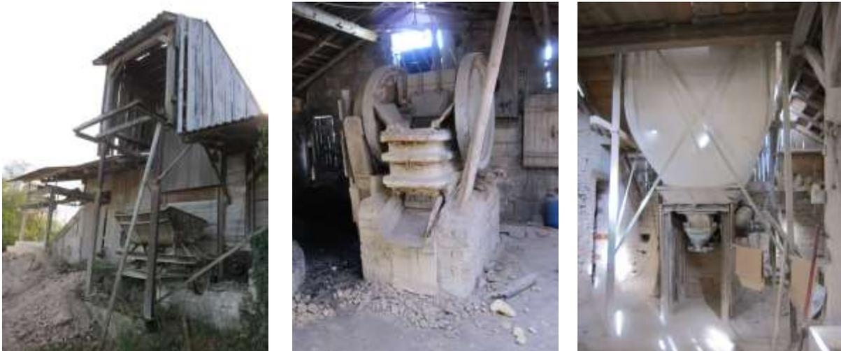
Abb. 6: links: mit Kalkmergel gefüllte Lore auf der Plattform des Außenaufzugs, Mitte: Backenbrecher, rechts: Silo der Mischanlage mit Absackanlage Fotos LWL-Denkmalpflege 10.2014 (Reck)
