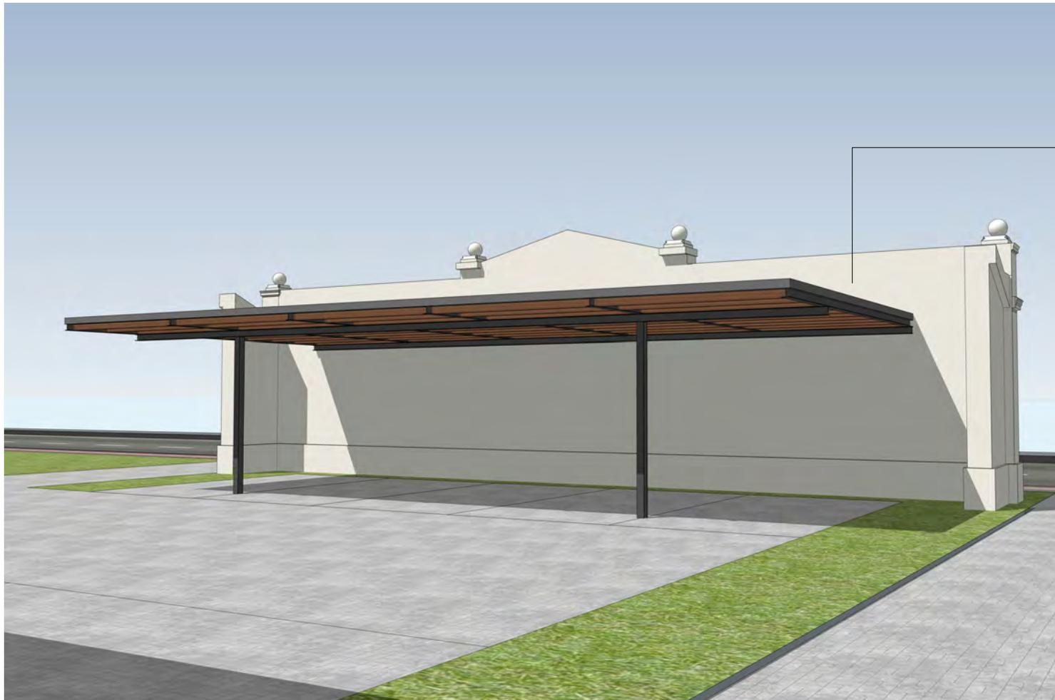
Die Anbindung des Carports an die Bestandsfassade dient zeitgleich der Aussteifung der Bestandsfassade.
