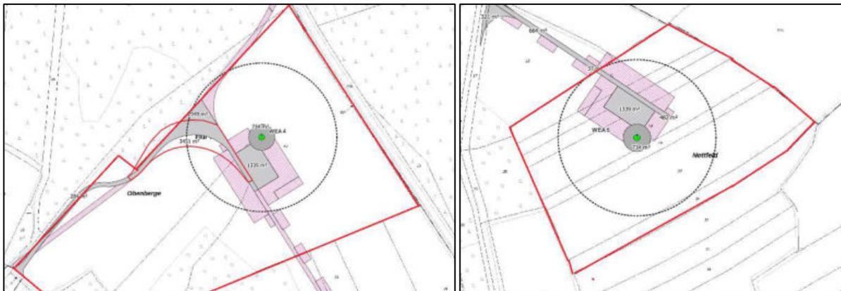
Abbildung 8: Grobe Übersicht zur Abgrenzung der Eingriffsflächen des BImSchG-Verfahrens (rot); Eingriffsflächen der WEA mit Rotorkreis.
