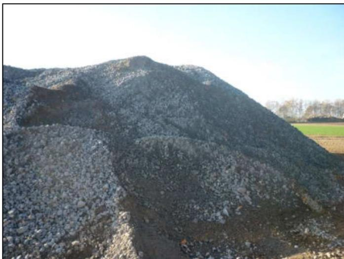
Abbildung 10: Überreste eines entfernten und zerkleinerten WEA-Fundamentes (enveco GmbH).
