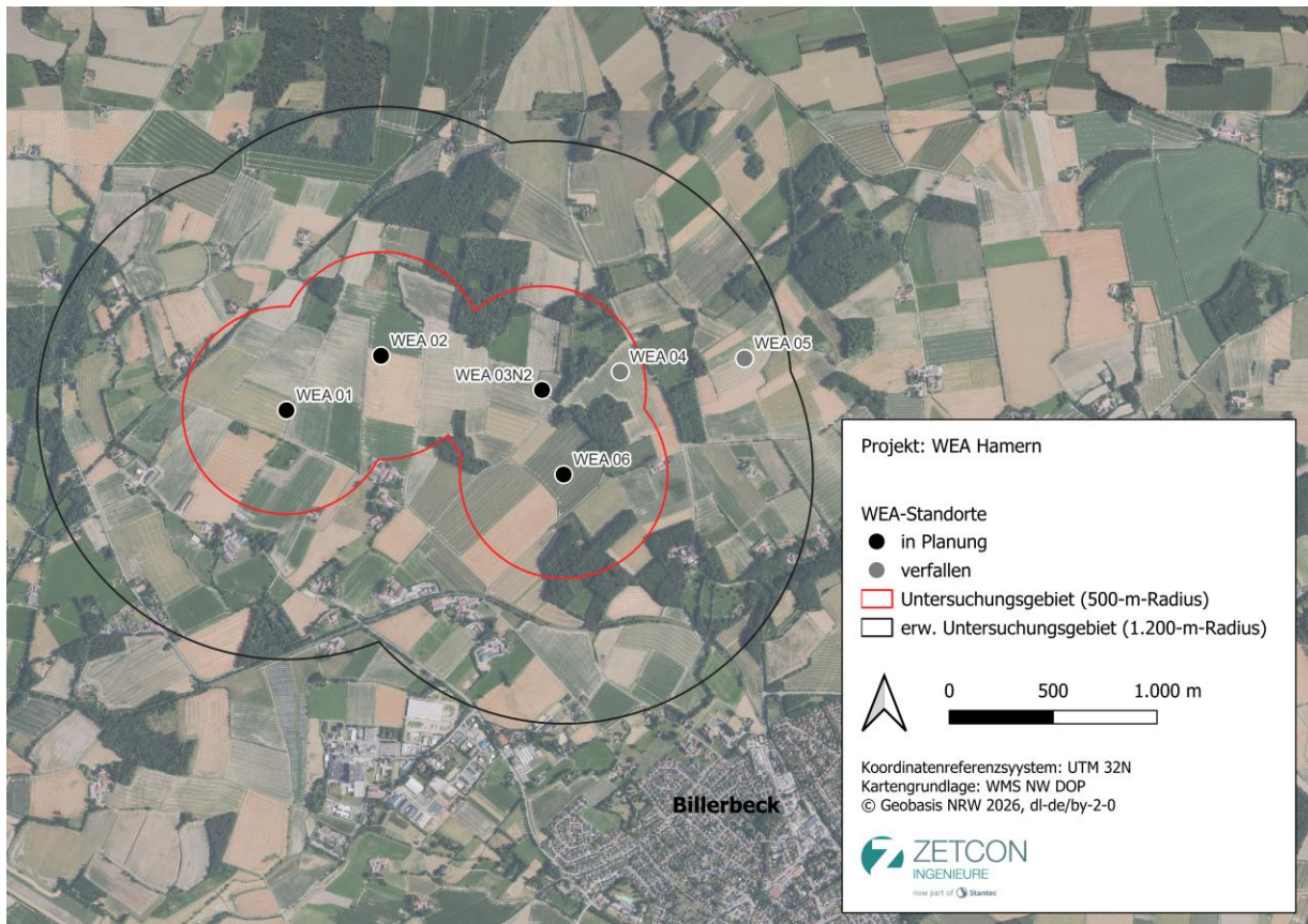
Abbildung 1: Lage und Abgrenzung des Untersuchungsgebietes mit Radien von 500 m bzw. 1.200 m um die geplanten Windenergieanlagenstandorte. Die WEA-Standorte 4 und 5 sind in dieser Abbildung als Bestandteil des Ensembles mit eingezeichnet. Die Standorte dieser beiden WEA befinden sich bereits im Genehmigungsprozess.
